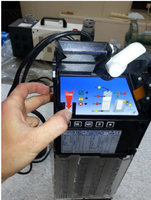
Überprüfen ob die Münzprüfklappe geschlossen ist. Die kleine Stahlfeder muss eingeklemmt sein damit die Klappe bei Betätigung des Retoungabe-Hebels sauber zurück federn kann. Auf das **Close** Symbol drücken.
