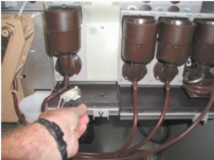
Ausschnitt zum Ausbau des Laufrädchens : mit einem Finger "A" die innere gerädelte Krone halten und mit der anderen Hand das Laufrädchen "B" ausbauen.
