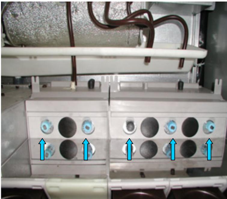
**Zahnradgetriebe der Motordosiervorrichtungen zum Einrasten der Pulverbehälter**
