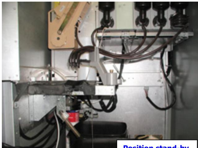
Zur Gewährleistung einer besseren Hygiene und ein optimales Aussehen der abgegebenen Produkte, wurde eine spezifische neue Gruppe **"bewegliche Düsen"** entwickelt
